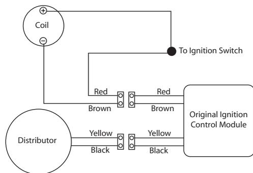
Figure 2 (ORIGINAL FACTORY WIRING)
